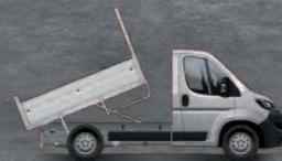
Benne sur châssis cabine
